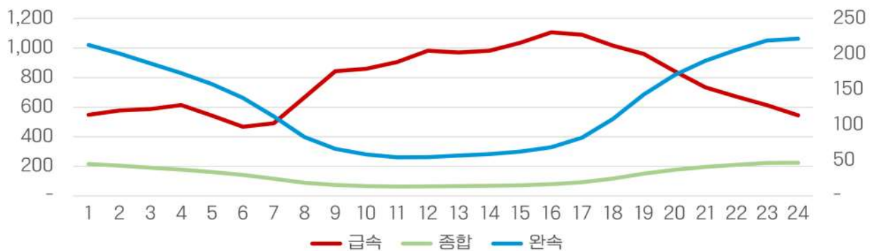
<그림 5> 공동주택시설의 충전기당 시간대별 평균 충전 전력량 (좌측 : 급속, 종합 / 우측 : 완속)(출처 : 전력거래소)
