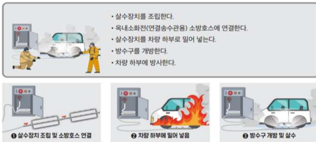
<그림 16> 상방향 살수장치 사용요령
